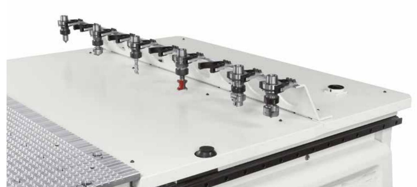
Máxima versatilidad gracias al almacén lateral **TR** que reduce significativamente los tiempos de cambio de utillaje. Solución ideal para reducir los tiempos de ciclo, especialmente en el recorte de placas de materiales avanzados y plásticos.
