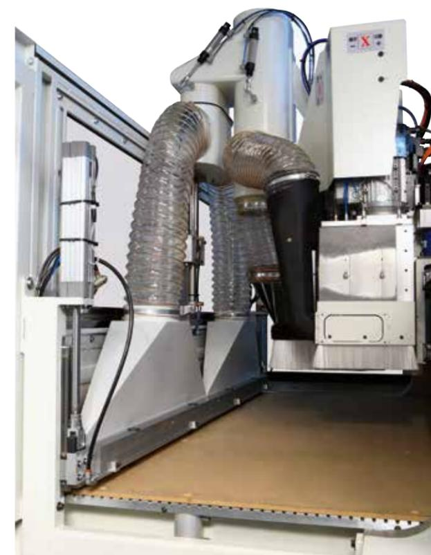
Cero polvo y la máxima eliminación de las virutas de plástico con el sistema de aspiración superior para la limpieza de la plataforma de trabajo.
