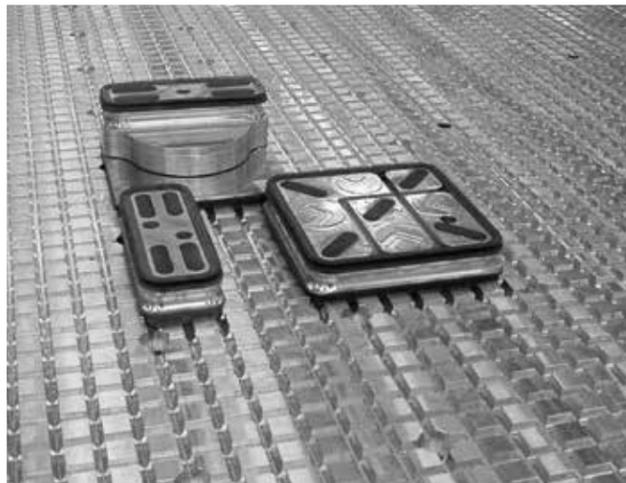
Amplia selección de ventosas MPS y MODULSET para sujetar las piezas a la plataforma de trabajo en función del mecanizado a realizar. Dispositivos especialmente eficaces en el mecanizado más complejo de placas y artículos técnicos.
