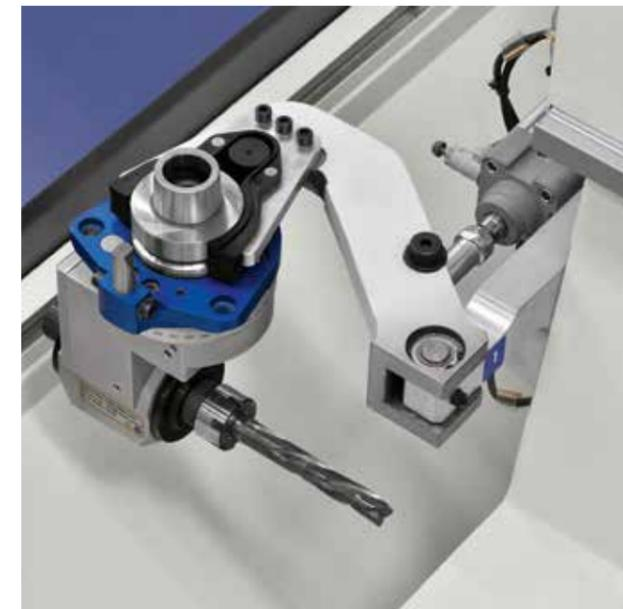
Almacén **"Pick-up"** de 1 posición con posicionamiento neumático anclado al travesañomóvil. Configuración ideal para el uso de voluminosos cabezales de transmisión angular.
