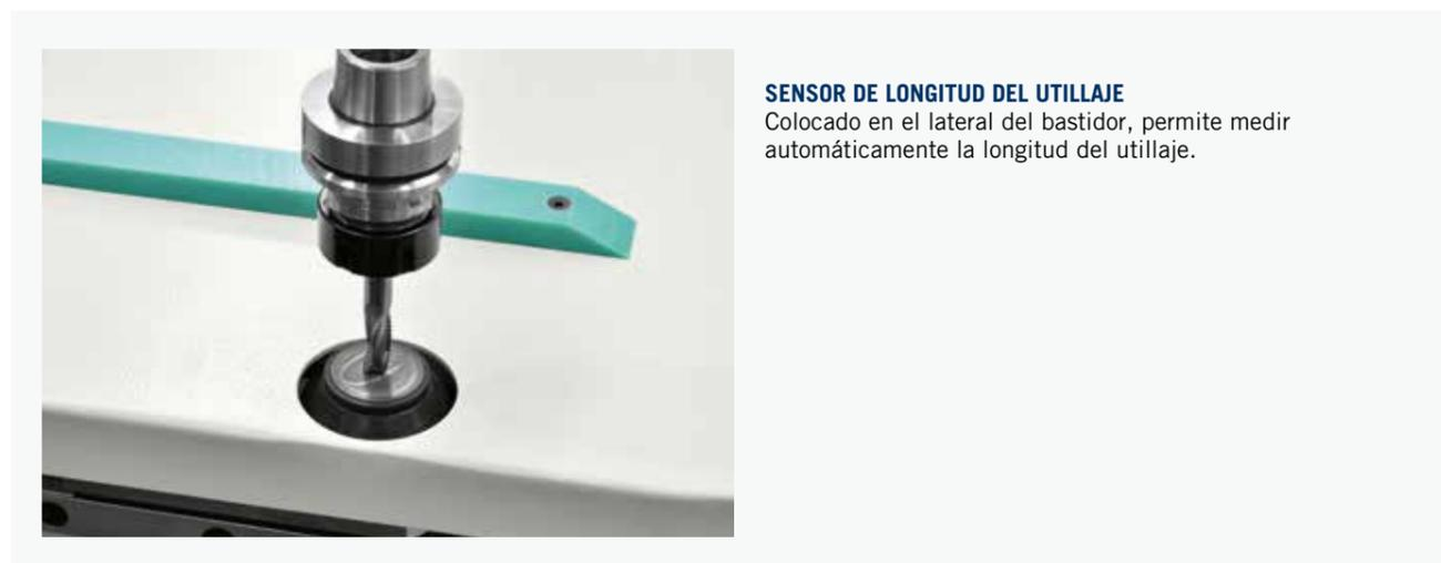
**SENSOR DE LONGITUD DEL UTILLAJE**
