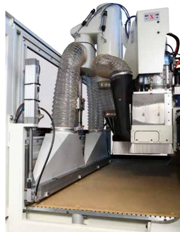
Zéro poussière et évacuation maximal des copeaux de plastique avec le système d'aspiration servant au nettoyage de la table de travail.
