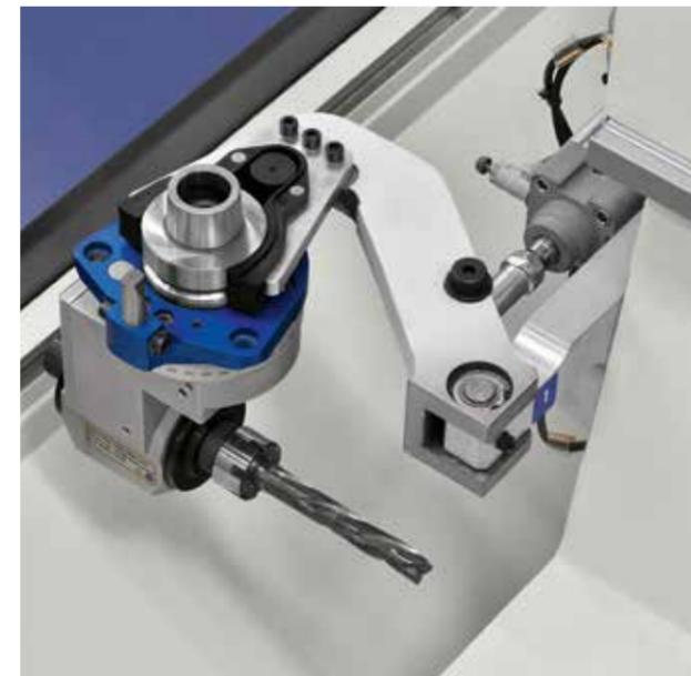
Magasin "**Pick-up**" à 1 station avec positionnement pneumatique embarqué à la traverse mobile. Configuration idéale pour l'utilisation de têtes à renvoi d'angle encombrantes.
