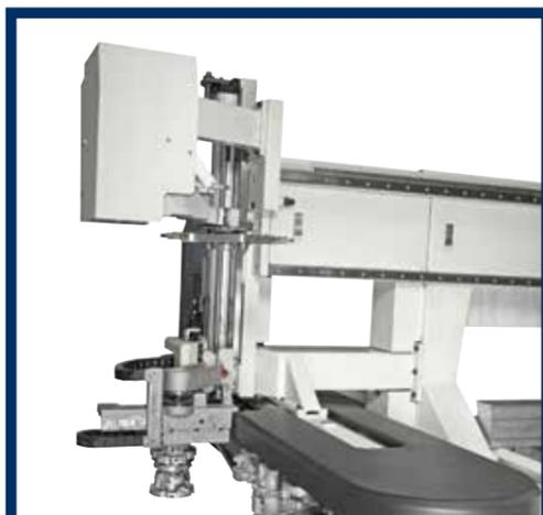
O dispositivo MACH 5 executa a operação da troca de ferramenta em apenas cinco segundos, reduzindo drasticamente o tempo improdutivo.
