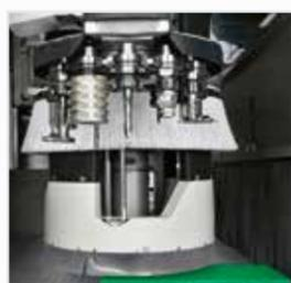
Excelente limpeza da máquina e do ambiente graças à dupla câmara de aspiração coaxial, que permite a extracção de lascas e pó em todas as condições de trabalho.
