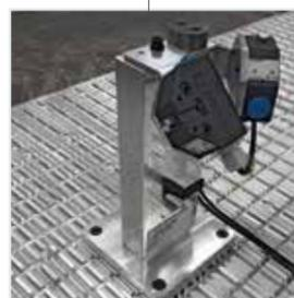
A precisão da máquina de 5 eixos garantida pelo dispositivo de regulagem RTCP (Rotation Tool Centre Point), que restaura automaticamente os parâmetros da unidade operador por meio de um sistema de auto-calibração. Uma solução indispensável para tirar o máximo proveito da usinagem de 5 eixos, particularmente para artigos técnicos e componentes de materiais avançados.
