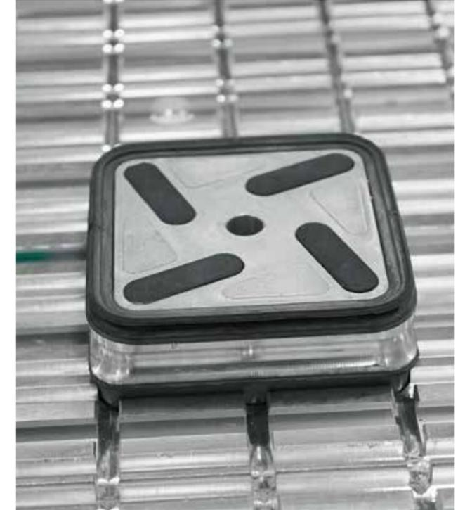
É possível configurar a mesa de trabalho com inúmeros tipos de ventosas MPS, adicionando-as ou removendo-as facilmente, dependendo do tipo e geometria das peças a serem fixadas. Solução ideal na produção de artigos técnicos de material plástico.
