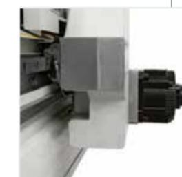
**Ausência total de vibrações** mesmo a alta velocidade com a estrutura de pórtico accionada por um duplo motor. Solução dedicada à usinagem de materiais plásticos e de materiais avançados.
