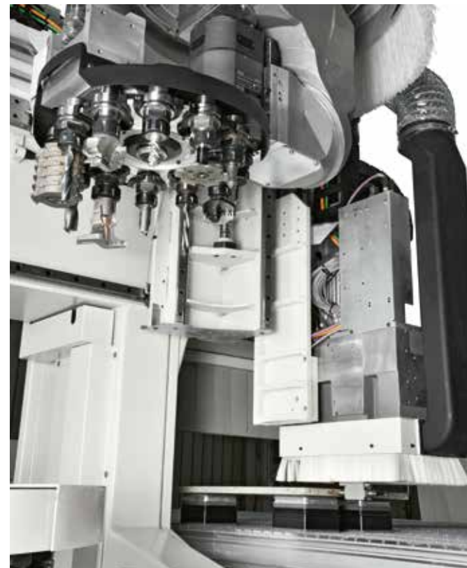
RAPID 12 ON-BOARD 12个刀位 圆盘式刀库位于操作单元上，负责冲孔作业中执行主轴刀具切换。
