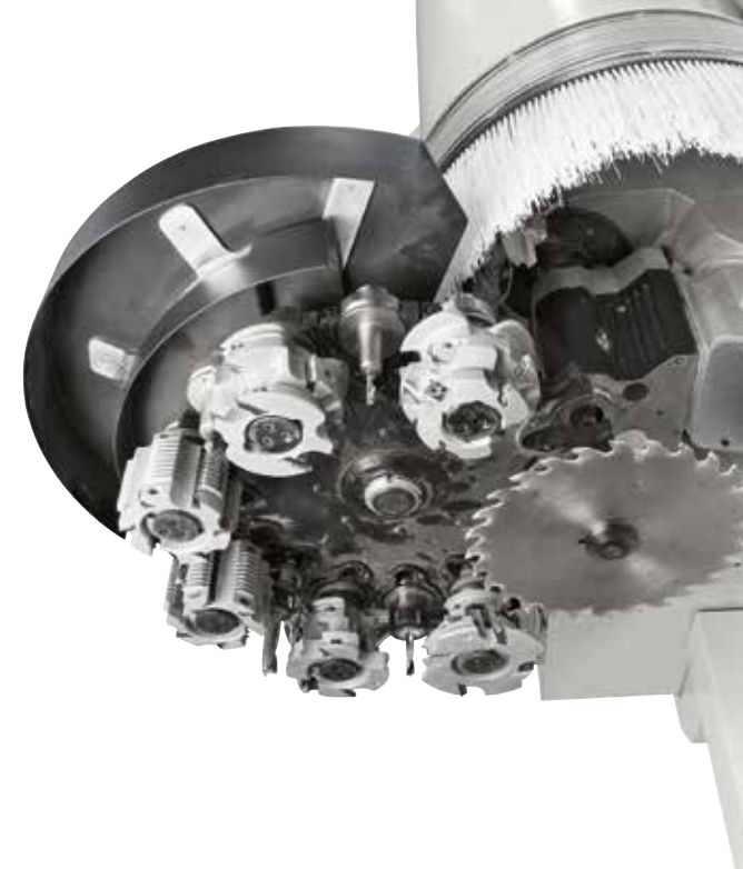
RAPID 24或16个刀位 圆盘式刀库固定在移动门架上，便于随时使用所有刀具。
