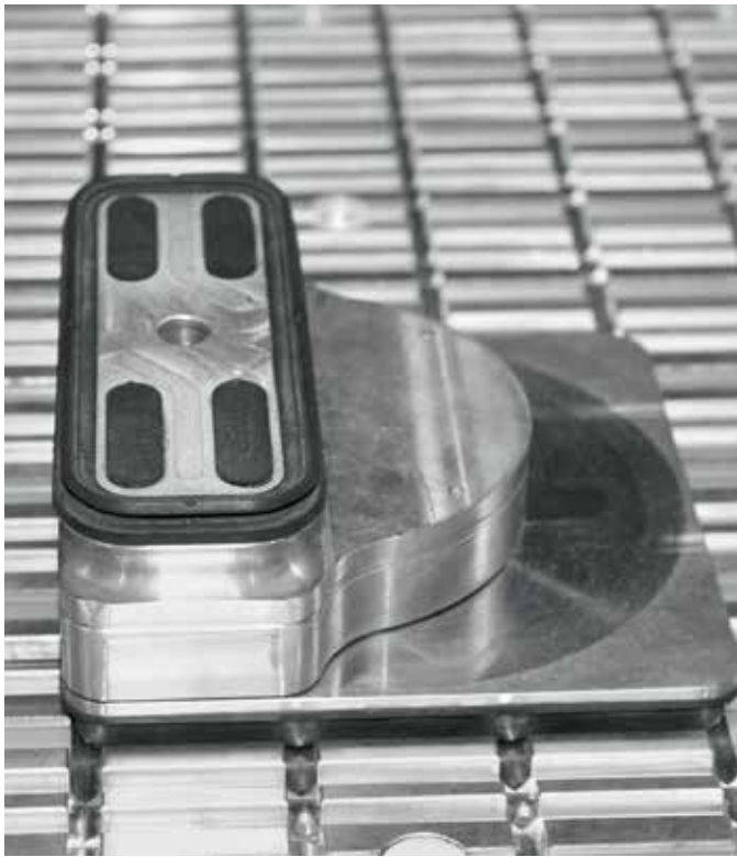
工作台的整个表面都有T型槽，可以牢固地固定任何对刀和紧固设备。
