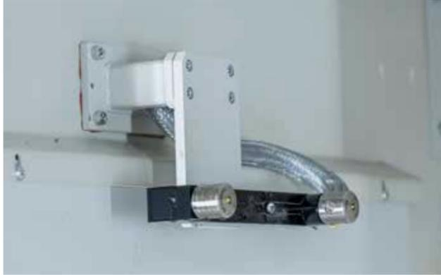
Dispositif laser pour la mesure du diamètre et de la longueur de l'outil
