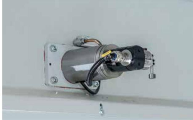
Dispositif de contrôle et de réaligement des axes rotatifs
