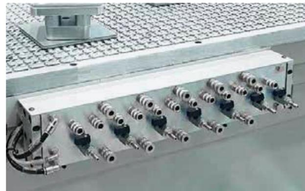
Groupe de raccordement au vide/à l'air comprimé
