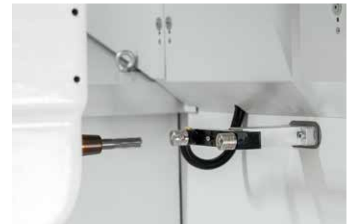
Sonda laser de pré-ajuste de ferramenta
