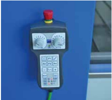
Botoeira remota para controlo de até 6 eixos que permitem operar perto do plano de corte e de configurar multi-fontes.
