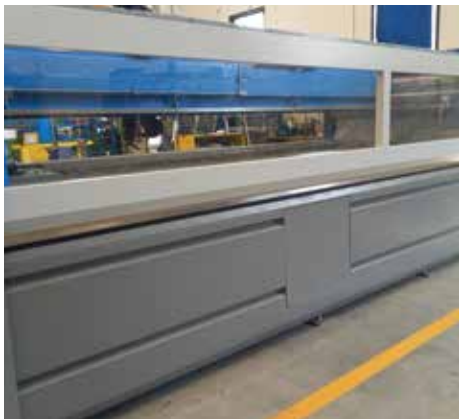
Porta frontal e traseira com movimento pneumático para melhor proteção da área de corte e contenção das reverberações de água e abrasivos.
