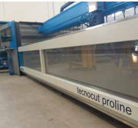
气控移动的前后门板可更好地保护切割区域并遏制水流与磨料反射。
