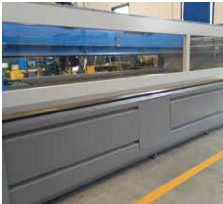
气控移动的前后门板可更好地保护切割区域并遏制水流与磨料反射。
