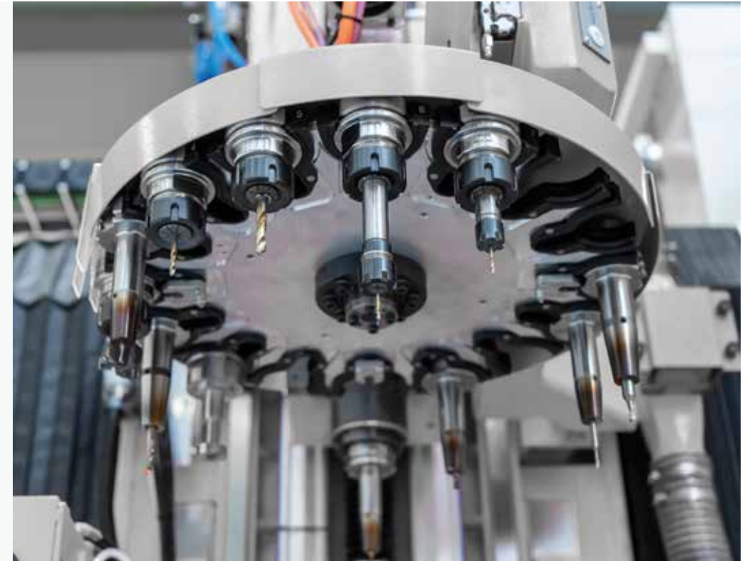
转盘式刀库 位于桥上或桥一侧的转盘式刀库可以放置8-16个刀具。
