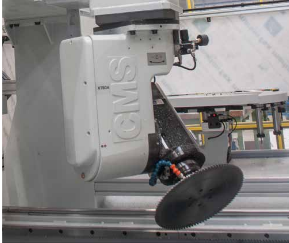
PX5 5轴单元，配备12到20kw主轴、冷却和润滑系统（刀具尖端有内部通道）和气动制动器。
