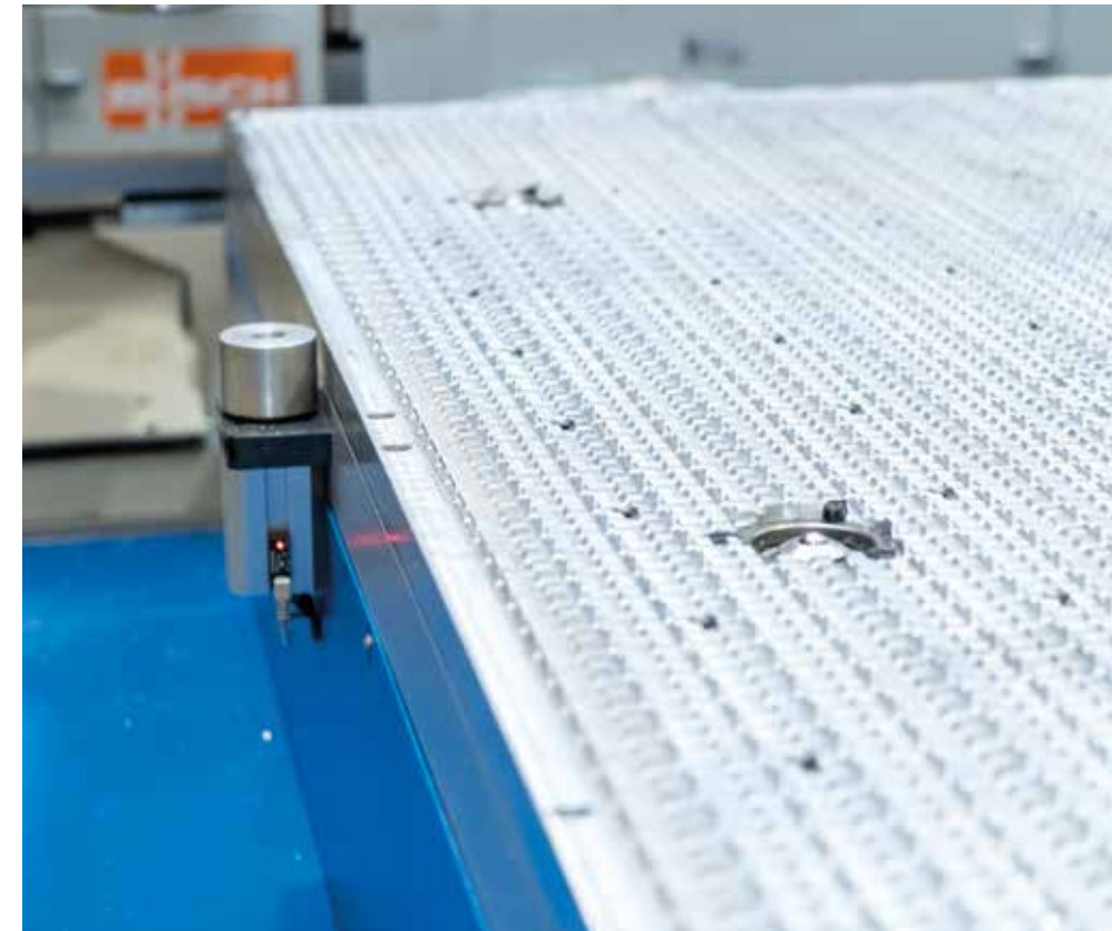
参考挡块 参考挡块（工作台外部或集成在工作台中）和集成球，有助于待加工板材在工作台上的移动，确保快速轻松地定位。
