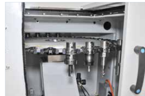
带30个工位的旋转刀库
