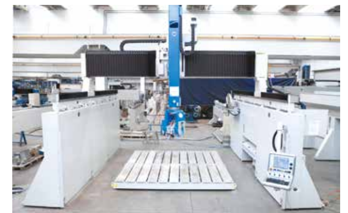
Axe Z jusqu'à 2 000 mm, pour usiner des pièces de forte épaisseur.
