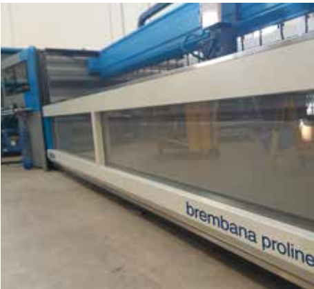
Porte avant et arrière avec mouvement pneumatique pour une meilleure protection de la zone de coupe et confinement de l'eau et des reflets abrasifs.
