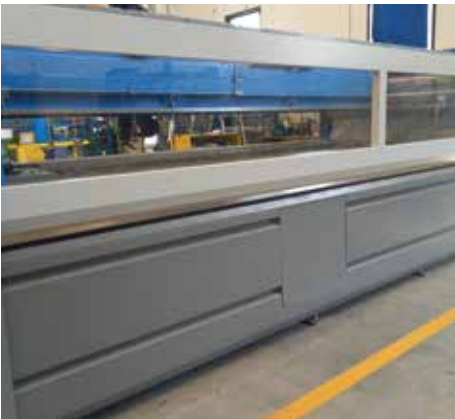
Porte avant et arrière avec mouvement pneumatique pour une meilleure protection de la zone de coupe et confinement de l'eau et des reflets abrasifs.
