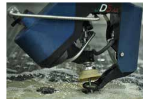
Le nouvel axe Z se déplace jusqu'à 350 mm pour 3 axes et jusqu'à 200 mm pour 5 axes.
