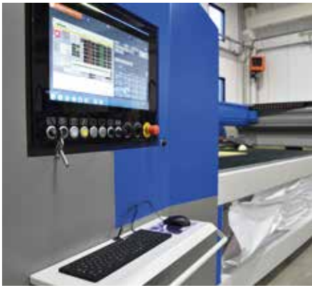
Panneau PC industriel 21,5" sur la machine avec écran tactile et interface HMI CMS Active.
