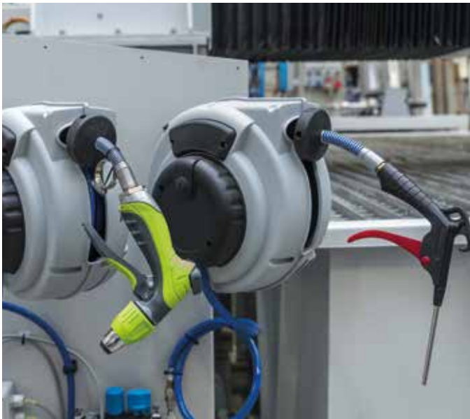
ENROULEUR AUTOMATIQUE DE TUYAU Kit de pulvérisation d'air et d'eau, utile pour nettoyer le matériau coupé à la fin du cycle.
