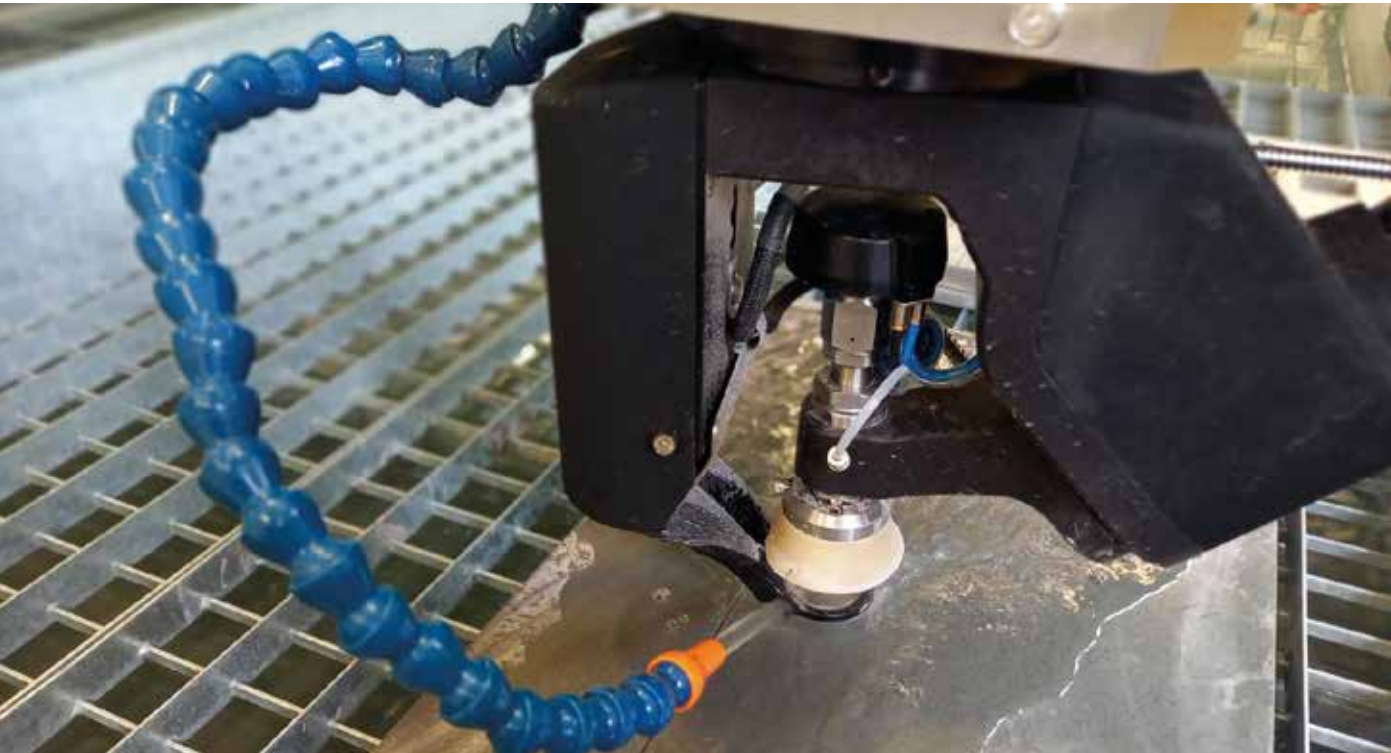
Système de lavage des pièces Système de lavage de la zone de travail pour réduire les risques de griffures sur les pièces. Cela permet aussi à la sonde de relever correctement l'épaisseur des matériaux.
