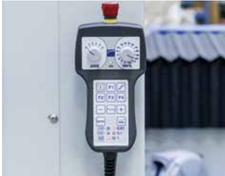
Panneau de commande à distance permettant de contrôler jusqu'à 6 axes pour travailler à proximité de la table de coupe et définir des origines multiples.
