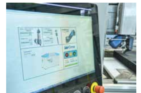
Matériel et logiciel de gestion de système de découpe au jet d'eau conçus pour offrir une interface opérateur simple et intuitive et permettre la gestion complète de toutes les fonctions du système, y compris le contrôle du cône (JDC) pour les machines à 5 axes.
