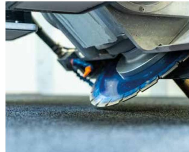
ELECTROMANDRIL controlado por un inversor que permite regular las revoluciones en un intervalo de 0 a 5000 rpm. Permite utilizar herramientas diamantadas, como fresas de ranurar o sierras de calar. La herramienta se cambia de forma manual.
