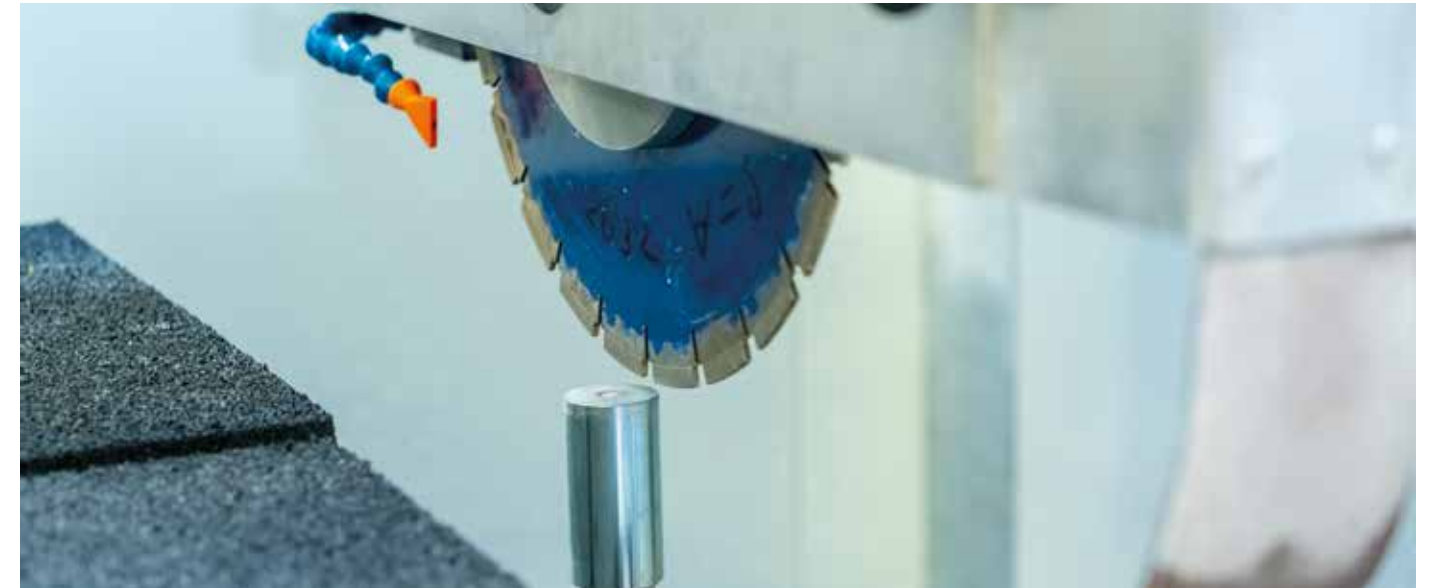
PRESETTING DISCO per misurare il diametro del disco e la lunghezza delle frese / foretti
