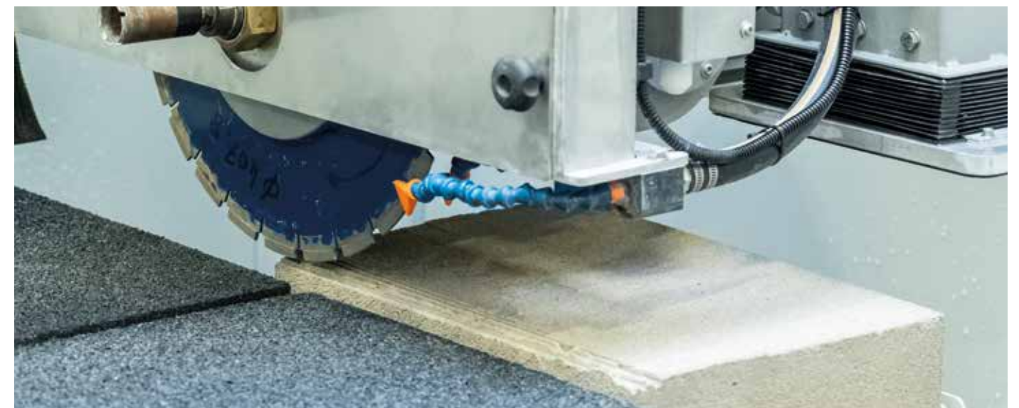
STAZIONE DI RAVVIVATURA AUTOMATICA del disco, attivabile mediante apposita funzione presente sul pannello operatore
