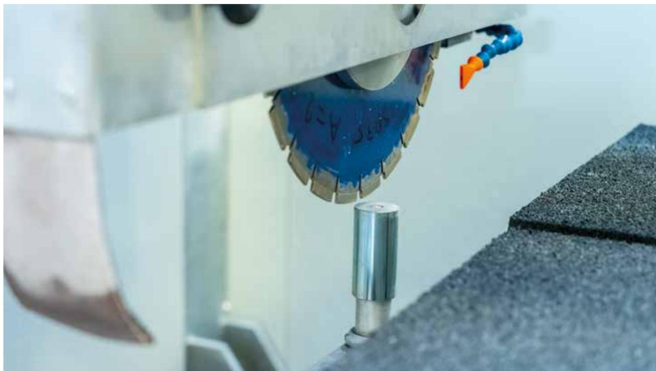
PRESETTING DISCO per misurare il diametro del disco e la lunghezza delle frese / foretti
