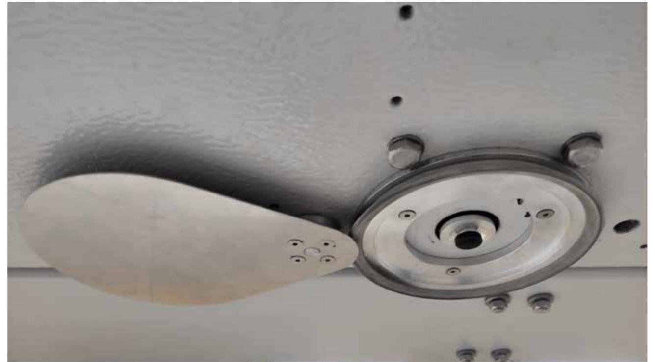
KAMERA: Werkstückerkennung auf dem Arbeitstisch. Schnellere Erfassung der Position des Stückes auf dem Tisch und Feststellung von Fehlstellen auf der Rohplatte
