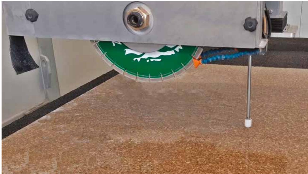
WERKSTÜCKDICKEMESSUNG zur automatischen Erfassung der Materialstärke
