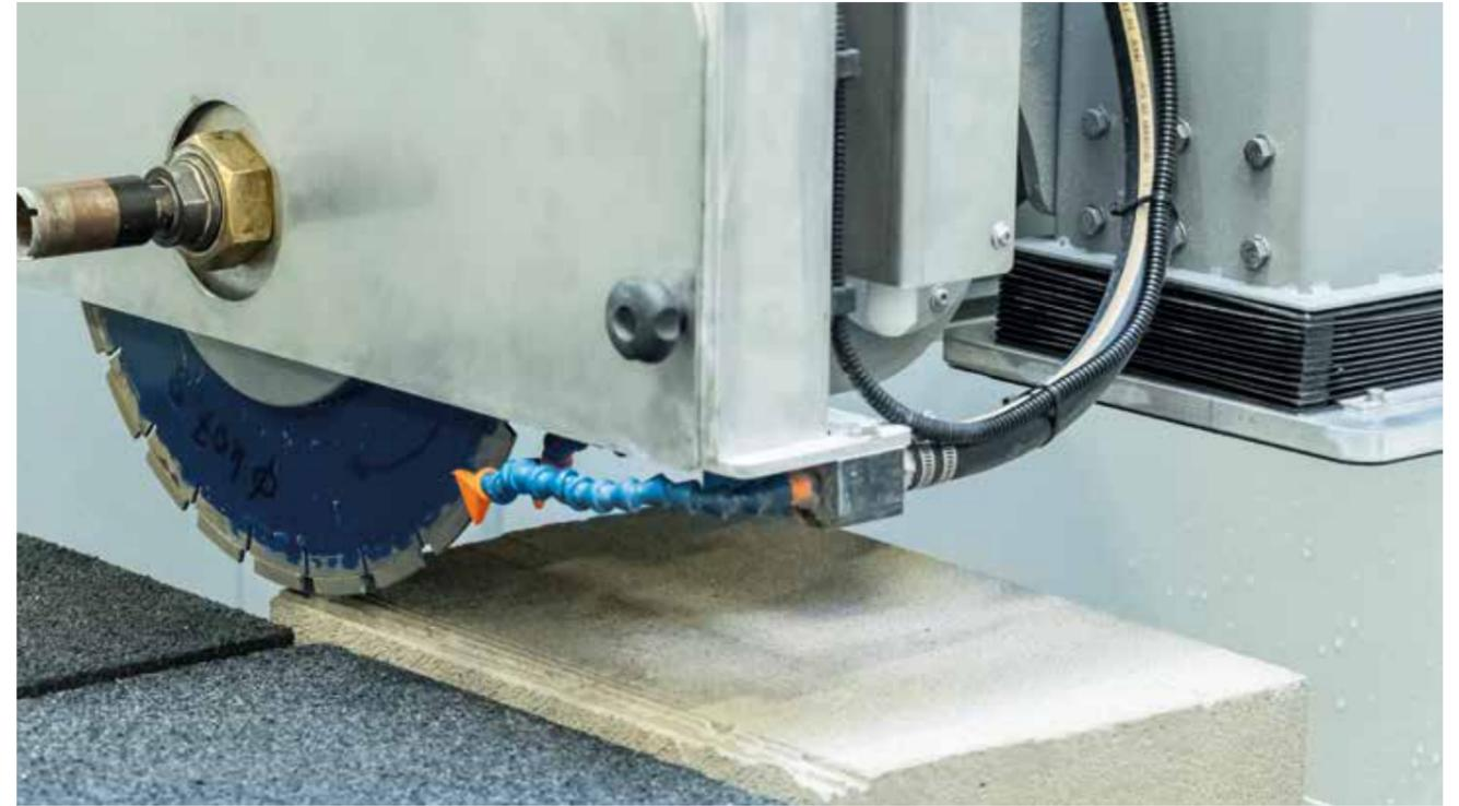
BLATTSCHÄRFSTATION ZUM ABRICHTEN des Sägeblattes, aktiviert über das Bedienpult
