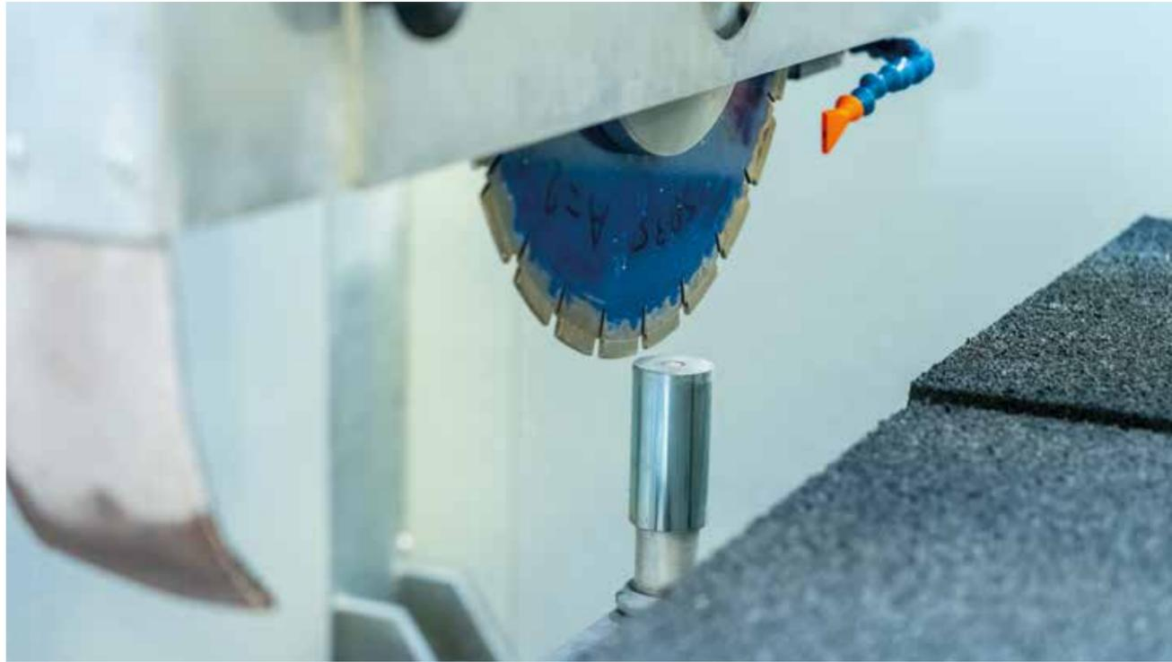
WERKZEUGVERMESSUNG zur automatischen Erfassung des Durchmessers des Sägeblattes oder der Länge von Bohrern oder Fräsern
