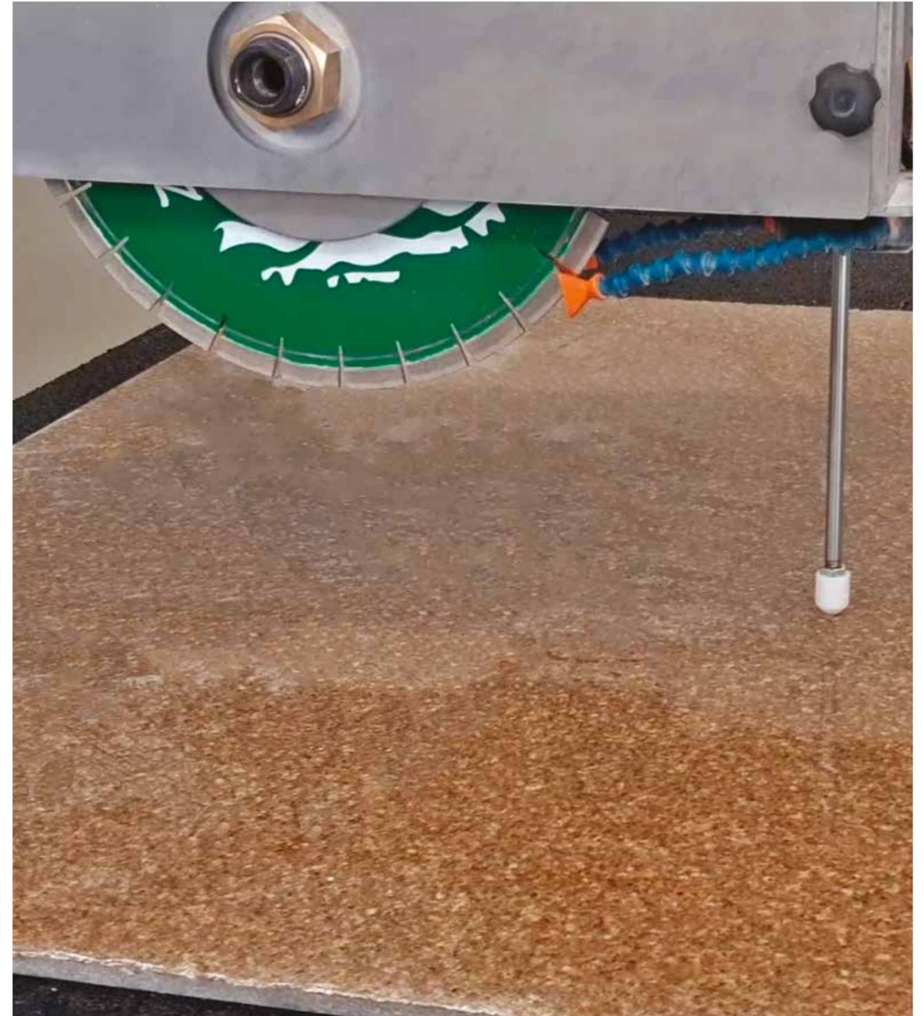
**SONDA DE ESPESOR DE LOSA** para detectar automáticamente el grosor de la pieza de piedra o cerámica, indispensable para la perfecta ejecución de cortes a 45 °.
