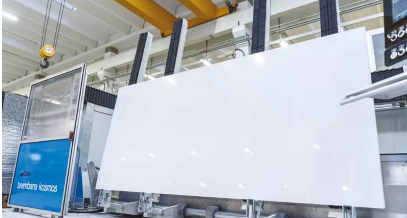
BANCO DE TRABAJO con 4 horquillas basculantes (opcional, con capacidad máxima de hasta 800 kg) y dimensiones 4000 x 2350 mm; la superficie de trabajo es de goma rectificada.
