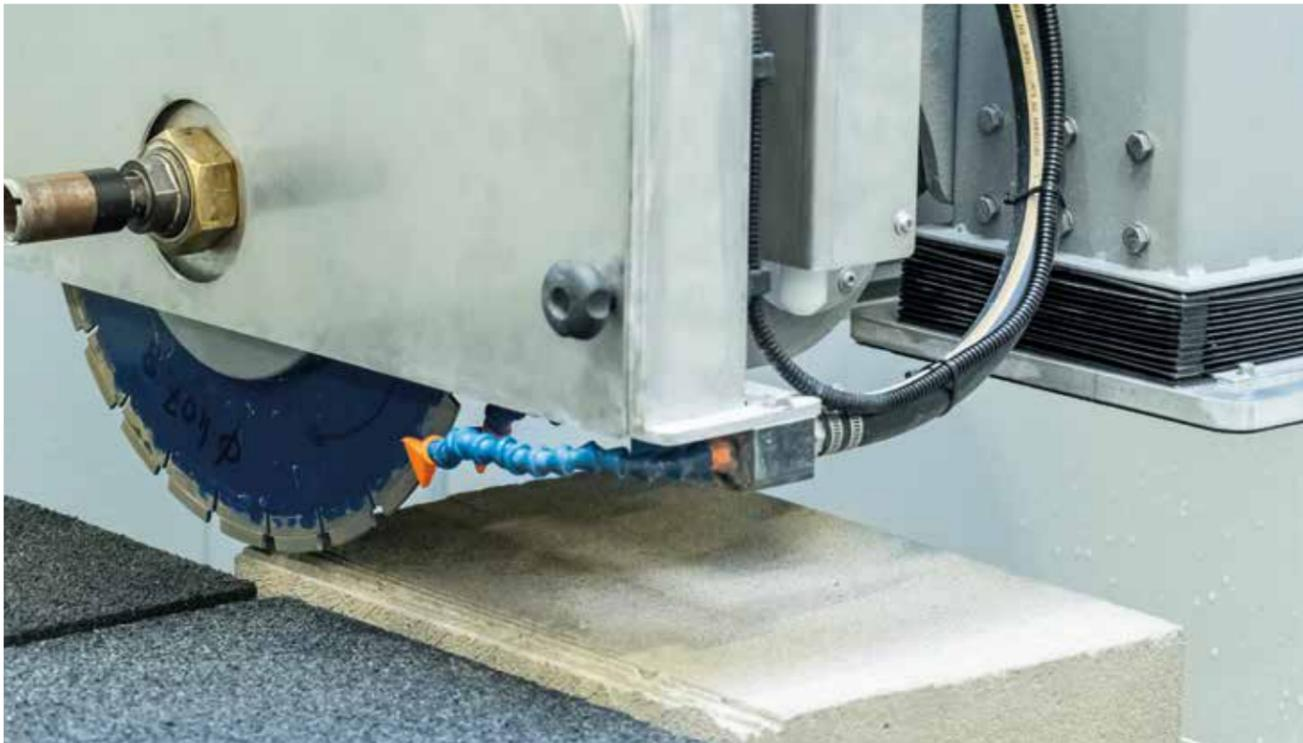
ESTAÇÃO DE REAVIVAMENTO AUTOMÁTICO do disco, ativável mediante específica função presente no painel operador.
