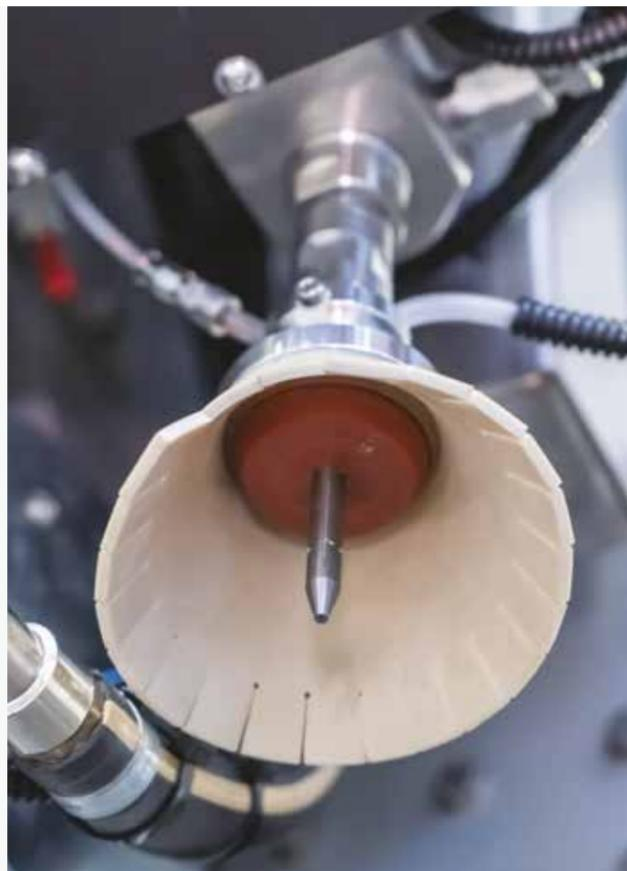
TRAMOGGIA ELETTRONICA per il controllo automatico della portata di abrasivo. Se il flusso di abrasivo si dovesse interrompere per qualsiasi motivo, il sistema verrà automaticamente arrestato per prevenire danni alla testa di taglio o rovinare il materiale. In aggiunta un sensore del vuoto collegato alla camera di miscelazione rileva costantemente variazioni nell'adduzione di abrasivo al getto d'acqua, fornendo in tempo reale informazioni sullo stato di usura della testa di taglio."
