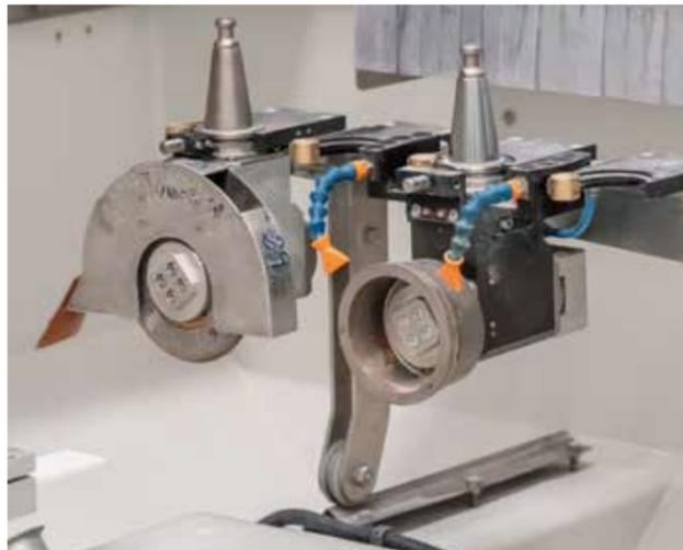
适用于平轮、杯形轮和抛光盘的90°正交斜轴齿轮箱。
