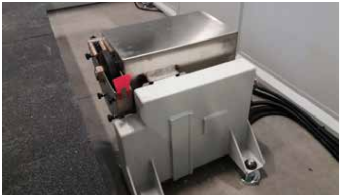
Unidade de corte por baixo para a realização de incisões na face inferior da placa, de modo a poder inserir os reforços para as bancadas de cozinha. Expansível também com a unidade de furação por baixo, para a realização de furos cegos dedicados às fixações para as bancadas de cozinha/casas de banho. As operações são geridas em automático pela máquina e requerem o emprego do manipulador de ventosas
