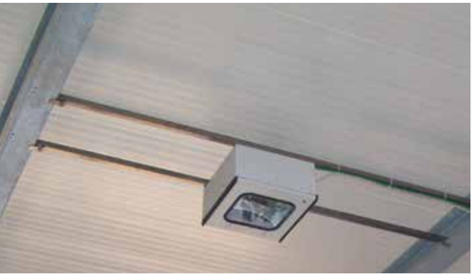
Sistema para a aquisição de imagens da bancada de trabalho que permite acelerar o posicionamento das peças de pedra e registar, também, eventuais defeitos da placa
