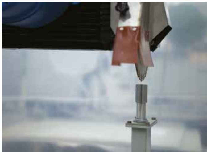
Preconfiguração do disco para medir o diâmetro do disco e o comprimento das cortadoras/brocas.
