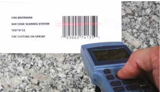
Leitor de códigos de barras fornecido completo com software específico para a leitura do código e ativação do programa de laboração
