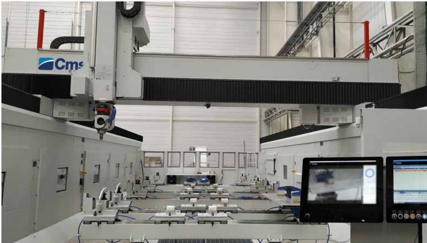
“零点”定位系统可快速精确地安装可互换组件
