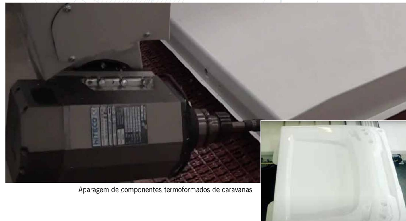
Aparagem de componentes termoformados de caravanas
