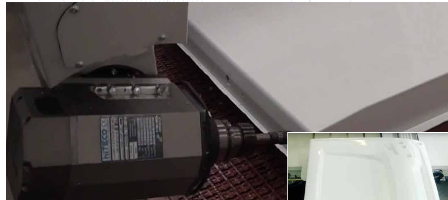
Zuschneiden thermogeformter Wohnwagenkomponenten
