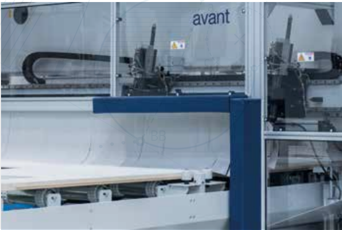
Hintere pneumatische Bohreinheiten mit durch NC einstellbarem Achsabstand
