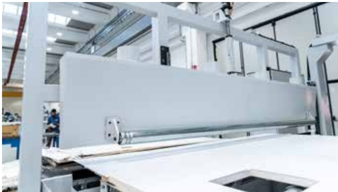
Reinigungsschiene am Auslauf, die durch die NC kontrolliert wird
