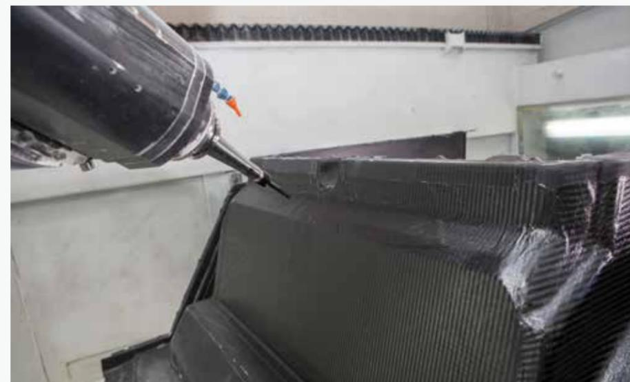
Mecanizado de componentes estructurales en fibra de carbono.
