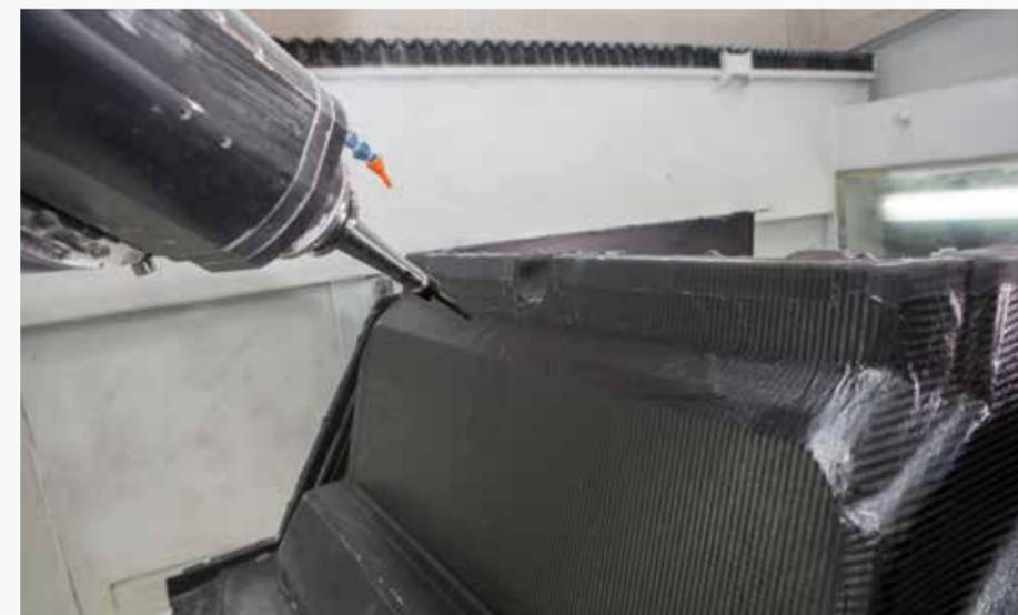
Laboraçon de componente estrutural em fibra de carbono.
