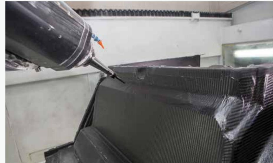
Bearbeitung von Bauteilen aus Kohlefaser.
