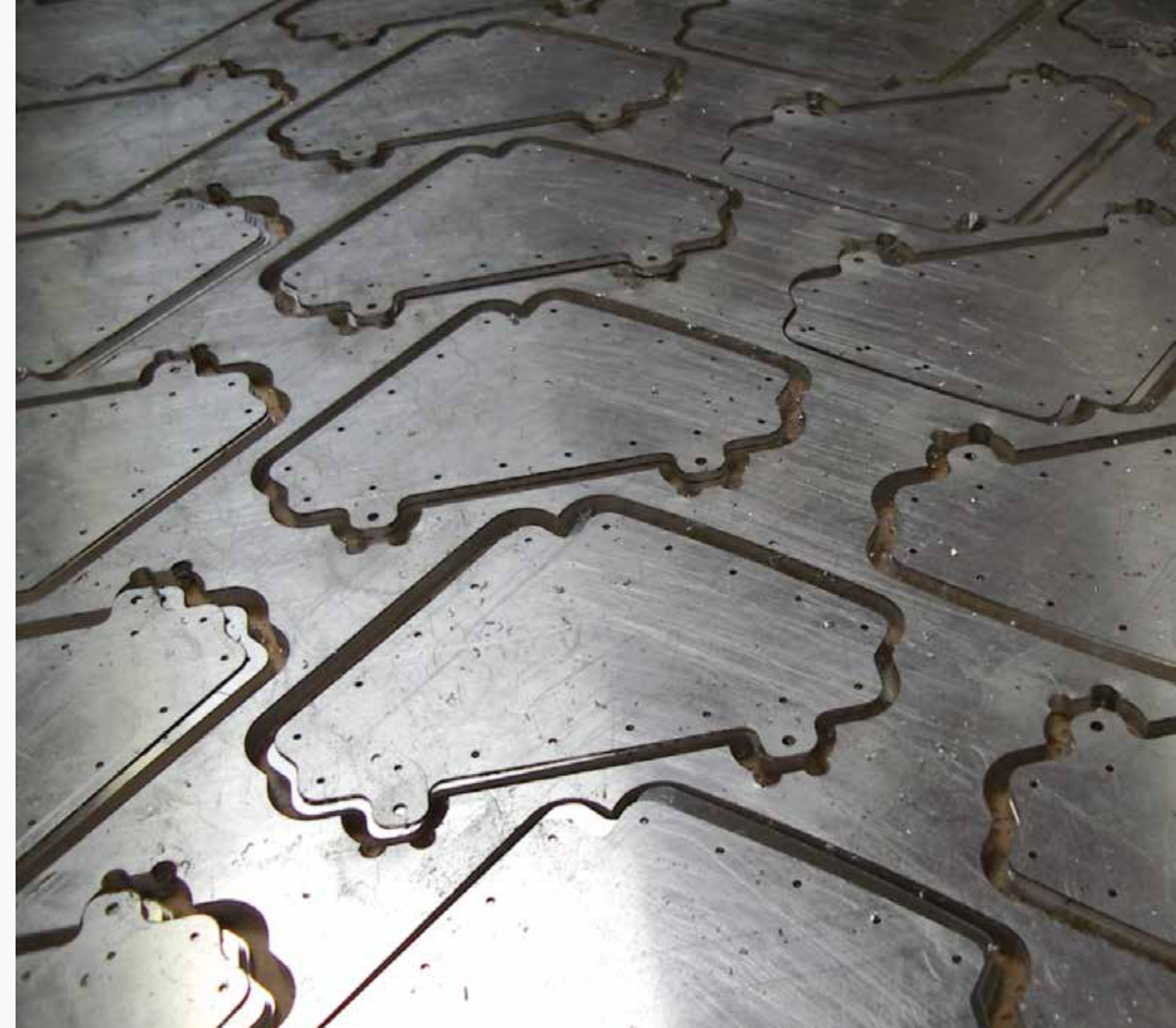
Mecanizado en paquete de placas de aluminio
