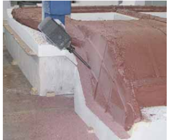
Tutti i percorsi della fresatrice CMS del costruttore nautico Numarine vengono generati dal software PowerMILL di Delcam.
